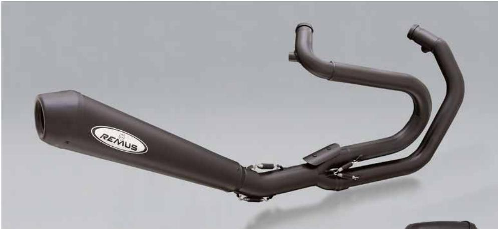
Komplettanlage 2-1 mit PowerCone Schalldämpfer /
